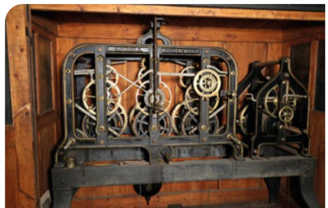
*Historisches Uhrwerk mit Uhrschatzwerk aus dem Jahre 1913, jetzt außer Betrieb da die Steuerung seit 1986 elektrisch erfolgt*
